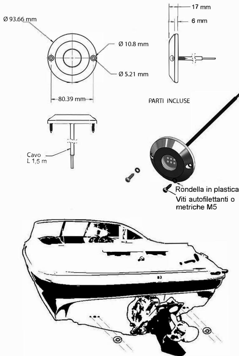
2. Fare un foro passante da 6 mm al centro del punto desiderato per far passare il cavo di alimentazione all'interno dell'imbarcazione. Tenere premuto il faro contro lo scafo e segnare i punti di montaggio delle viti. Fare un foro di marcatura per le viti di montaggio per prevenire screpolature nello scafo in vetroresina.
