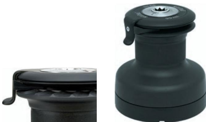
**Winch Self-Tailing XT Velocita' Diretta e Ridotta**
